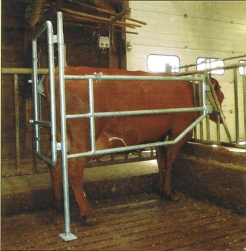
Das **Behandlungs- und Besamungssicherheitsgitter** ermöglicht dem Landwirt, Tierarzt oder Tierzuchttechniker ein stressfreies Arbeiten am Tier. Eine einfache Montage ist an jedem im Betrieb vorhandenen Fressgitter möglich. Das Gitter kann auf unterschiedliche Tiergrößen in Höhe und Länge angepasst werden. Die große Tür verhindert das Austreten des Tieres nach hinten und bietet zudem einen Aufspringschutz gegen andere Tiere.
